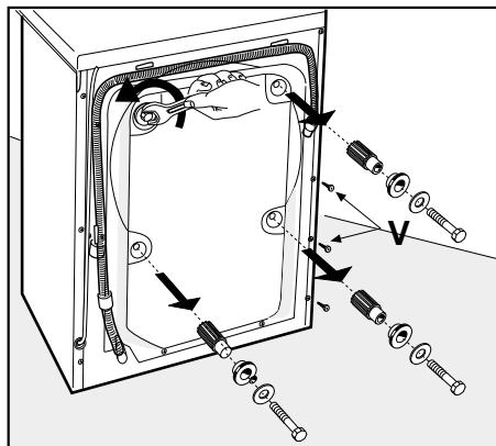
Для транспортировки качающийся узел машины зафиксирован 4 распорками на винтах. Перед тем как приступить к использованию машины, открутите блокировочные винты и выньте их вместе с блокировочными распорками. Сохраните винты и распорки для возможных переездов в будущем.
