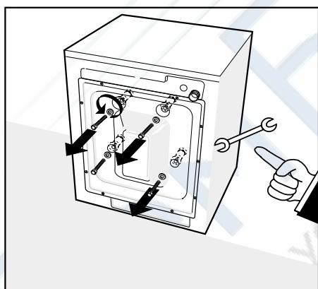
Для транспортировки качающийся узел машины зафиксирован 4 распорками на винтах. Перед тем как приступить к использованию машины, открутите блокировочные винты ключом.
