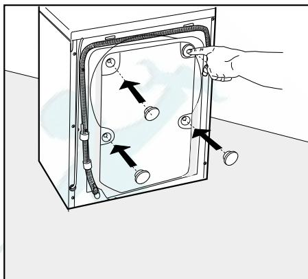
Закройте отверстия на задней панели прилагаемыми в комплекте заглушками.
